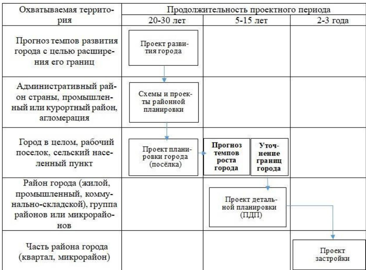
Рис. 1.4. Система градостроительного планирования
