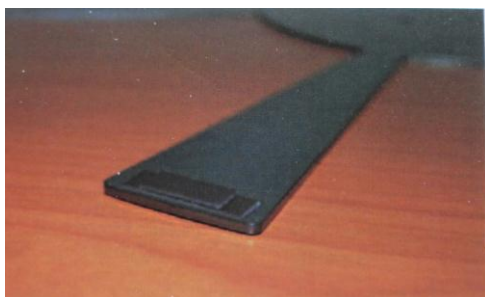
Рис. 4.31. Присоединение дополнительных масс к периферийной части лопаток при эксперименте
