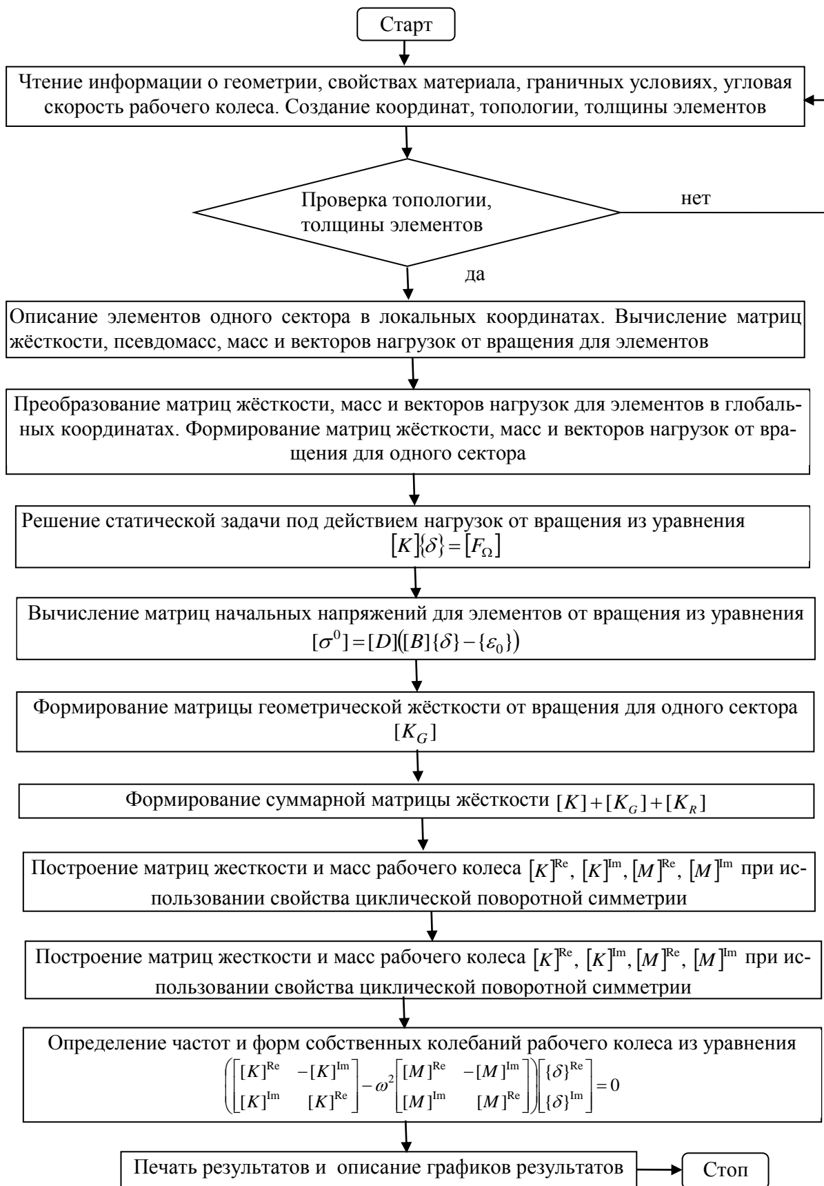
Рис. 3.15 Блок-схема алгоритма расчёта влияния вращения на характеристики собственных колебаний рабочих колес турбомашин
