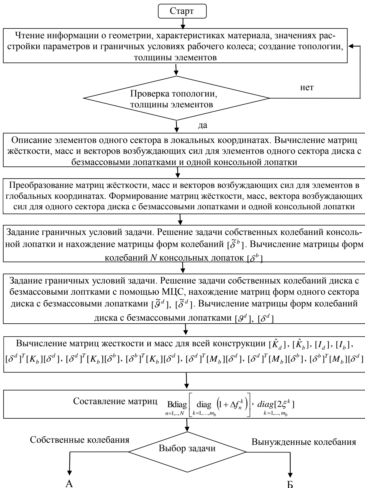
Рис. 4.13. Блок-схема алгоритма расчёта влияния расстройки параметров на характеристики колебаний рабочих колес турбомашин
