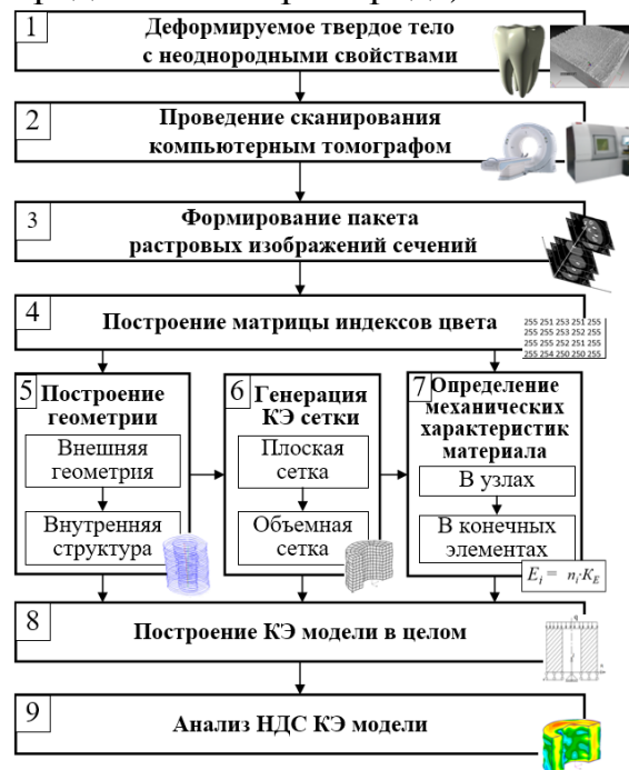
Рисунок 8 – Математическое и КЭ моделирование реальных ДТТ
