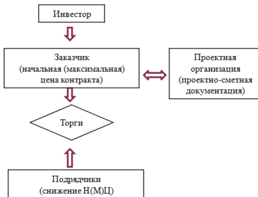
Рисунок 22. – Существующая схема взаимодействия основных участников инвестиционно-строительного процесса
