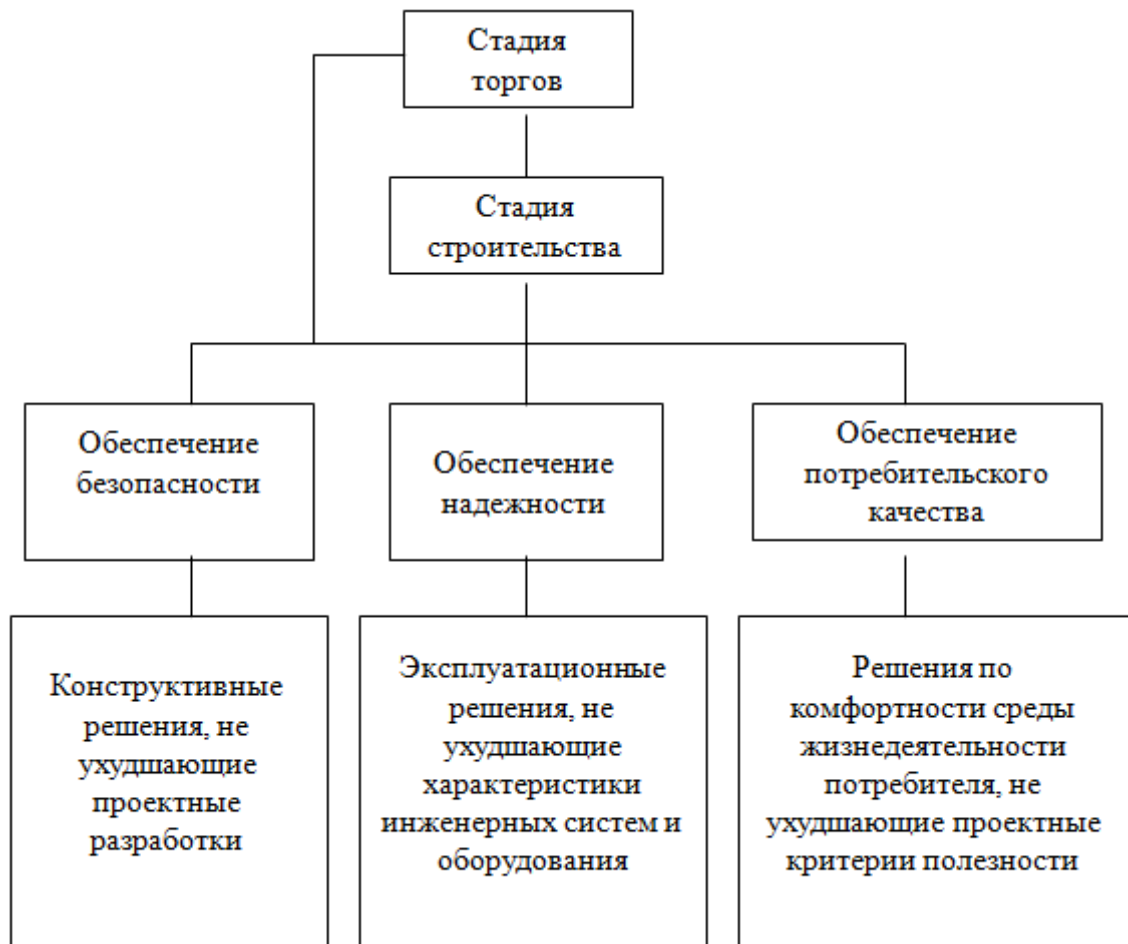
Рисунок 10. – Обеспечение проектных требований на стадиях торгов и строительства объектов недвижимости (составлено автором)
